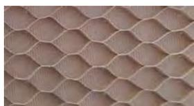
Un remplissage alvéolaire pour des panneaux légers : 10 kg/m<sup>2</sup>.
